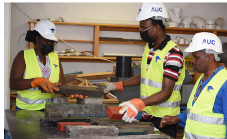
Production de matériaux de construction alternatifs à base de plastique recyclé; crédit photo: Habitat for Humanity
